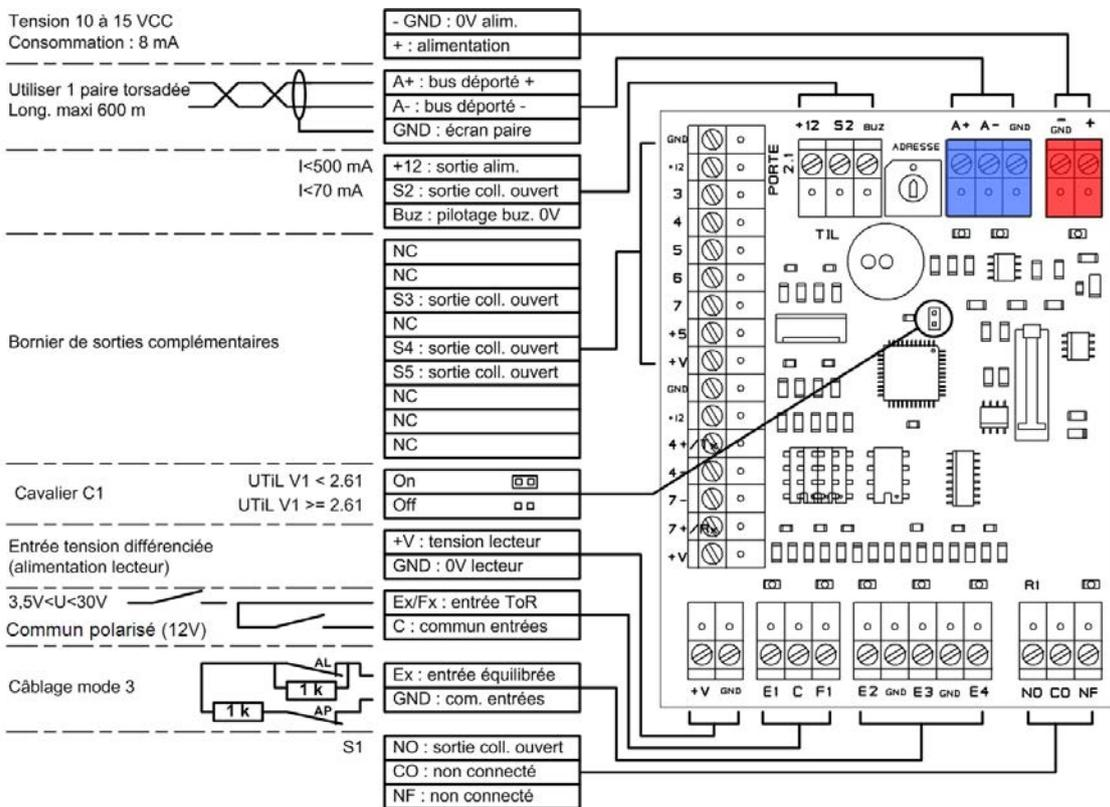
**Protection des équipements :** Afin d'assurer un parfait fonctionnement des équipements et éviter les interférences, raccorder le 0 volt des cartes électroniques à la terre.
